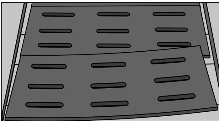
En superposant exactement les fentes des tapis caoutchouc par-dessus les fentes des caillebotis béton
