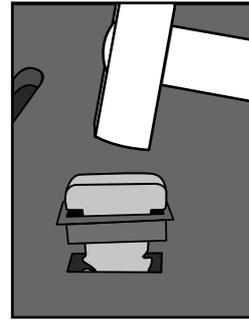
Frapper les pistons caoutchouc dans les fentes béton à travers les évidements prévus dans le tapis
