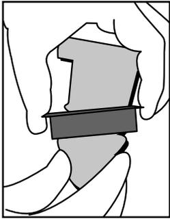
Enfiler la fixation caoutchouc dans l'élément plastique
