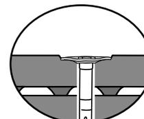
**i Astuce :** pour vérifier, vous pouvez utiliser un objet métallique plat (p. ex. un marteau) et racler au-dessus de la zone où se trouve la fixation. Dans le cas où vous sentez la fixation, cela signifie qu'il faut la frapper encore plus bas !
